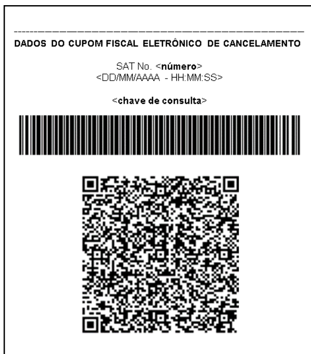
Figura 8 - Exemplo de rodapé de extrato de CF-e-SAT de cancelamento, em bobina contínua de papel largo (8cm), com o código de barras representando 44 caracteres.
