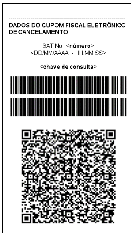
Figura 10 – Exemplo de rodapé de extrato de CF-e-SAT de Cancelamento, em bobina contínua de papel estreito (5,5 cm), com o código de barras dividido em dois blocos, representando em cada um deles 22 posições da chave.
