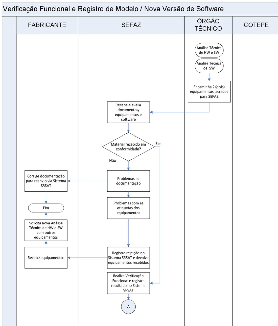
Figura 2 – Verificação funcional de modelo de SAT
