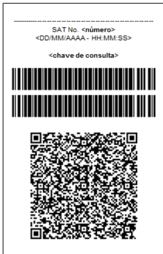
Figura 9 – Exemplo de rodapé de extrato de CF-e-SAT de Cancelamento em bobina contínua de papel estreito (5,5 cm) com o código de barras dividido em dois blocos, representando em cada um deles 22 posições da chave
