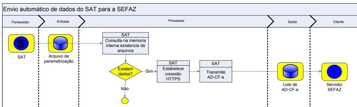
Figura 2 - Envio automático do Equipamento SAT para SEFAZ
